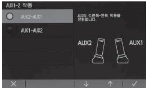
PTO 1-2 작동 화면 (PTO2-PTO1 선택 되었을 때)
